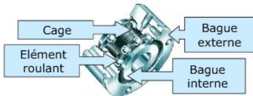
Figure 9: Les constituants d'un roulement [6]
