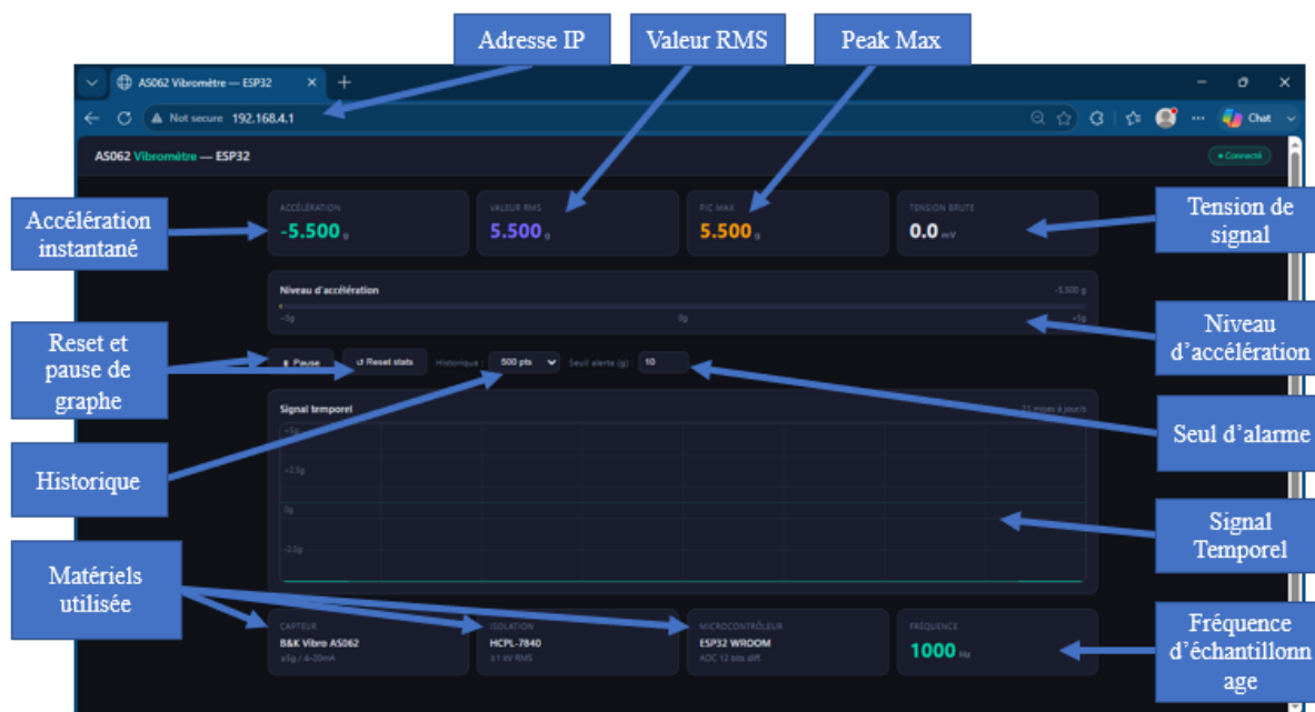
Figure 68 : Interface web d'acquisition des données mesurées pour le capteur AS - 062
