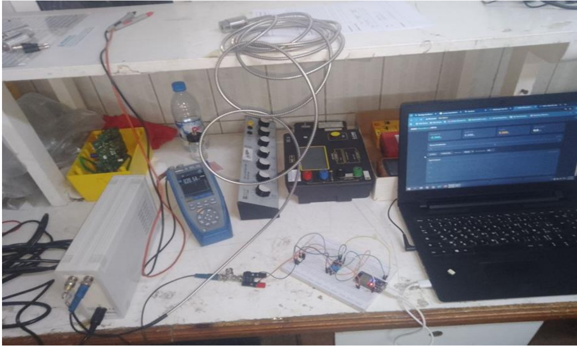
Figure 71 : Montage du circuit avec le capteur AS - 062
