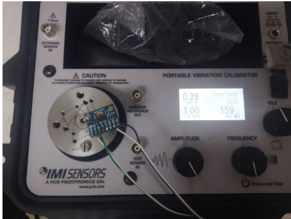
Figure 63: positionnement de capteur de calibré l'axe Z
