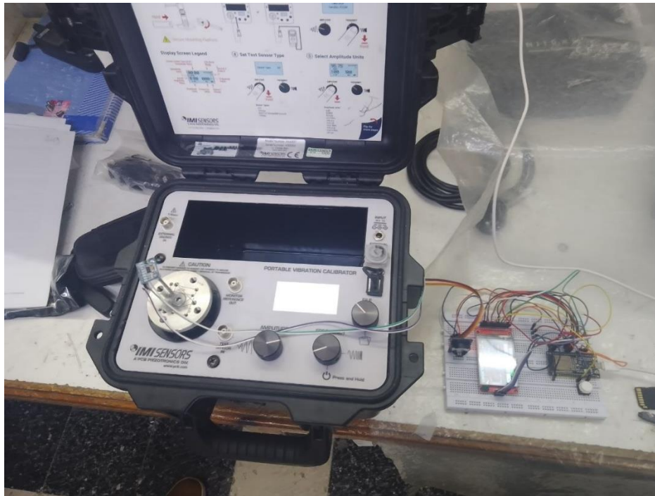
Figure 62: Essai de calibration du capteur ADXL345
