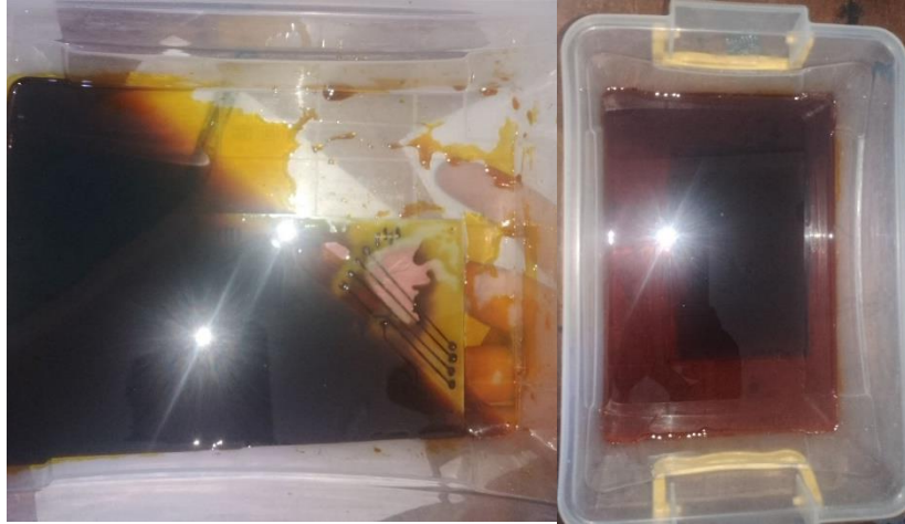
Figure 81: Immerger la plaque dans le chlorure de fer
