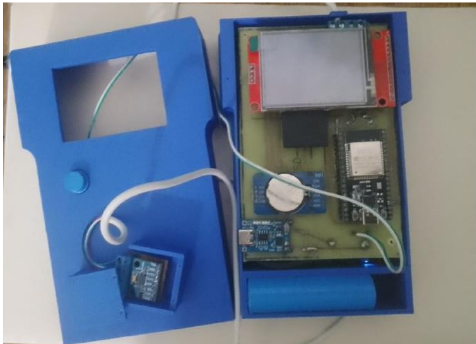
Figure 84: Plaque PCB soudé et positionné dans le boîtier
