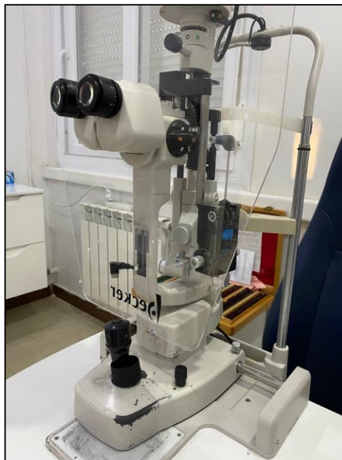
Figure 20 : Lampe à fente utilisée pour l'examen biomicroscopique de l'œil, notamment l'évaluation de la surface oculaire et l'ajustement lentillaire [80] .
