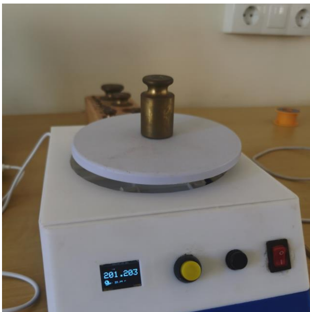
Figure 63 : Essai avec masse étalon 200g.
