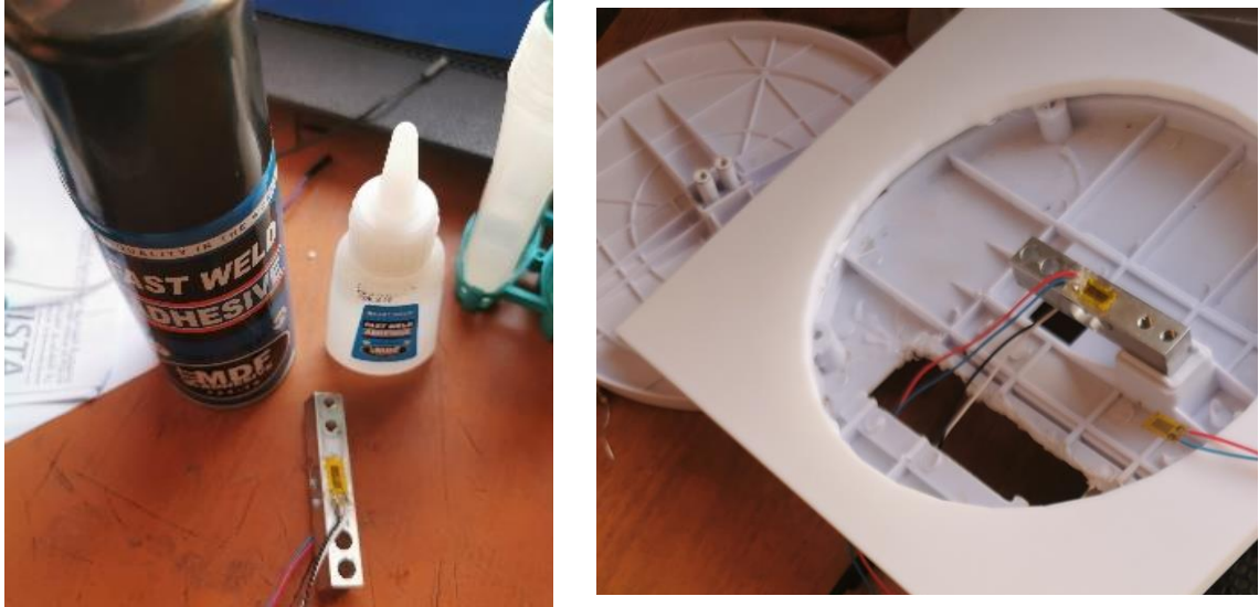
Figure 52 : Soudage et fixation. Après avoir collé les deux jauges pour bien fixer tout ça.
