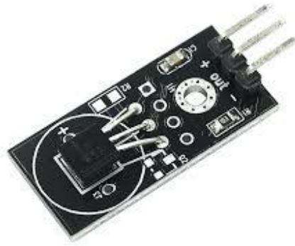
Figure 27 : Le capteur DS18B20 [9].
