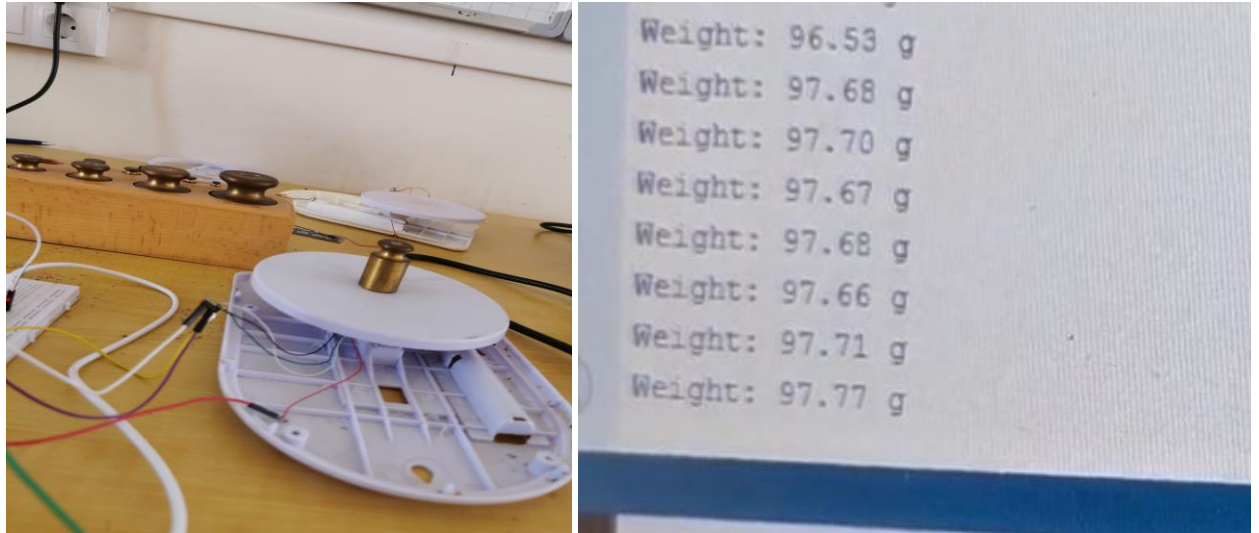
Figure 40 : Essais avec masse étalon 100 g.
