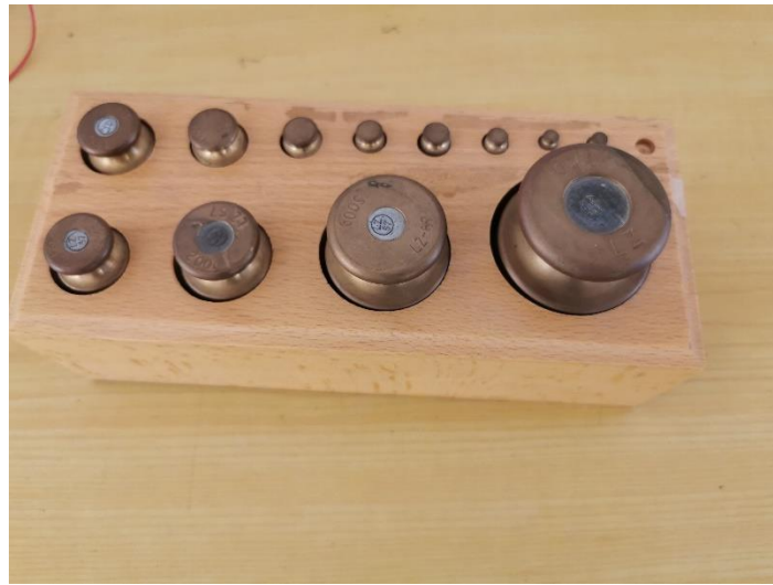
Figure 38 : Masses étalons Classe M.
