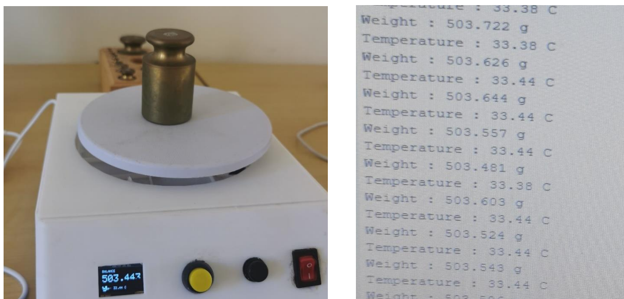
Figure 65 : Essai avec masse étalon 500g.
