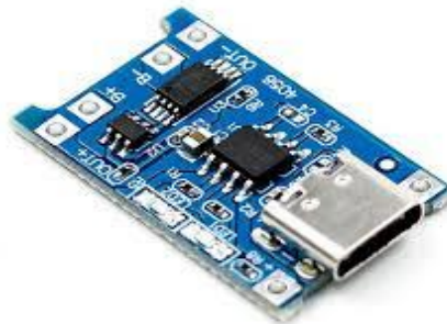
Figure 33 : Module de charge TP4056 [21].
