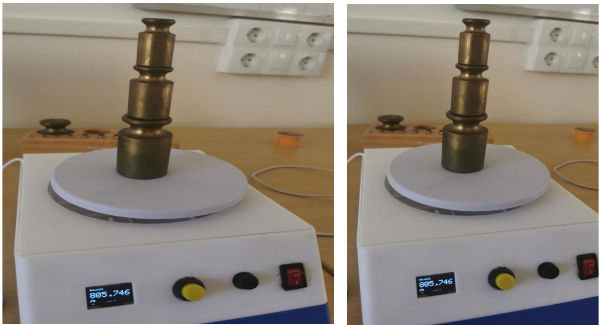
Figure 66 : Essai avec masse étalon 800g.
