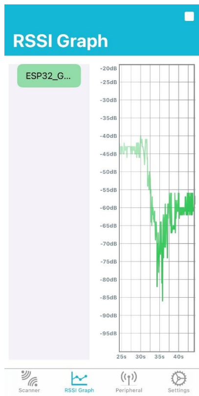
Figure 10 - Évolution temporelle du signal RSSI de l'ESP32 sur l'application nRF Connect
