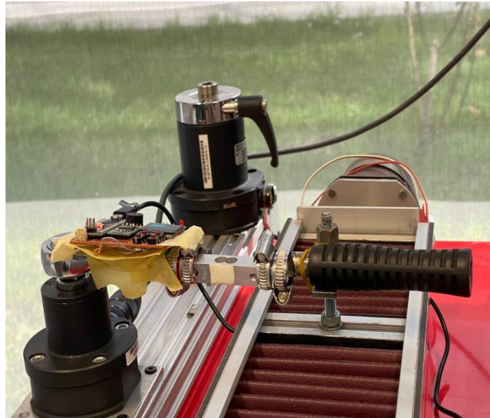
Figure 66 : Fixation de la clé a distance 18.5 cm
