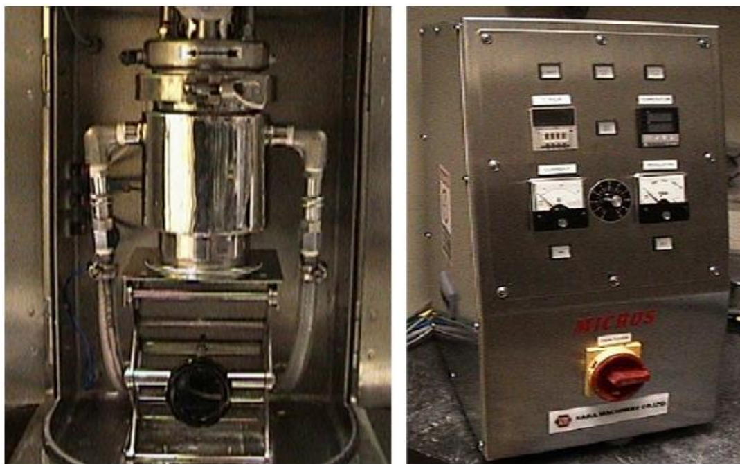
Figure II-9 : Réacteur hydrothermal mécano-chimique (MICROS : MIC-0, JAPON).
