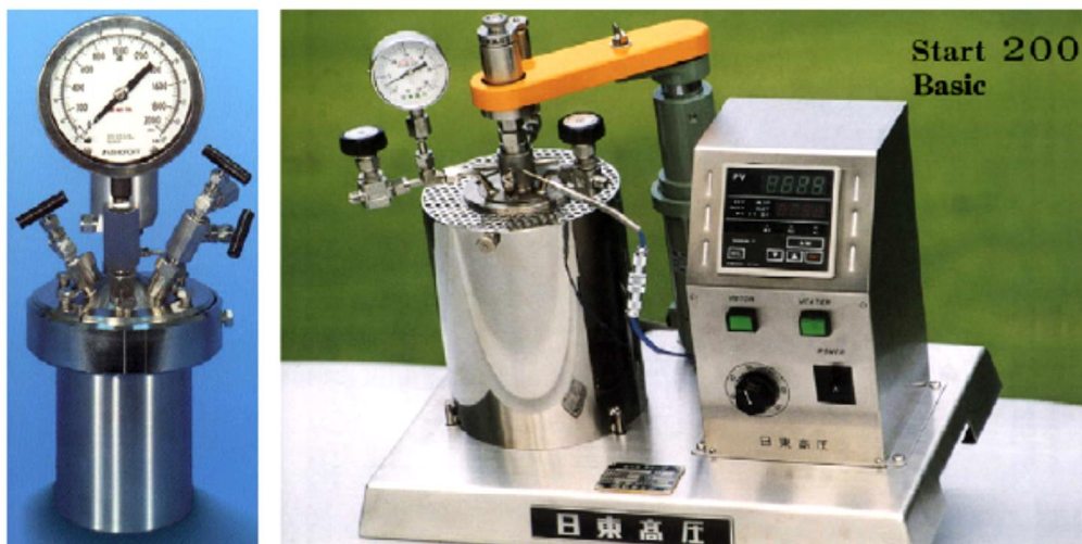
Figure II-7 : Les réacteurs avec système d'agitation commercialement disponibles : (a) munis des possibilités suivantes : le prélèvement du fluide pendant l'expérience ainsi que l'injection du gaz désiré à l'intérieur de l'autoclave couplé à un assemblage d'agitation magnétique. (b) possibilité de réaliser des trempes grâce à la circulation d'eau froide à travers des bobines de refroidissement fonctionnant à l'intérieur de l'autoclave [11].
