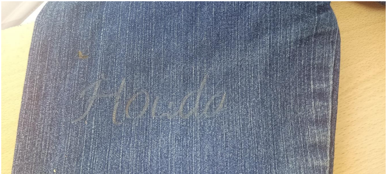
Figure 64. Le teste de laser sur le tissu jean
