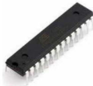
Figure 10. Exemple d'un microcontrôleur «ATmega 328p».
