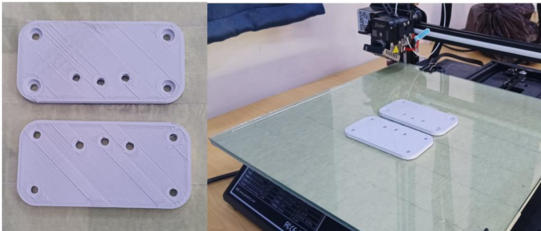
Figure 43. L'impression de la première pièce de l'axe Y avec sa couvercle
