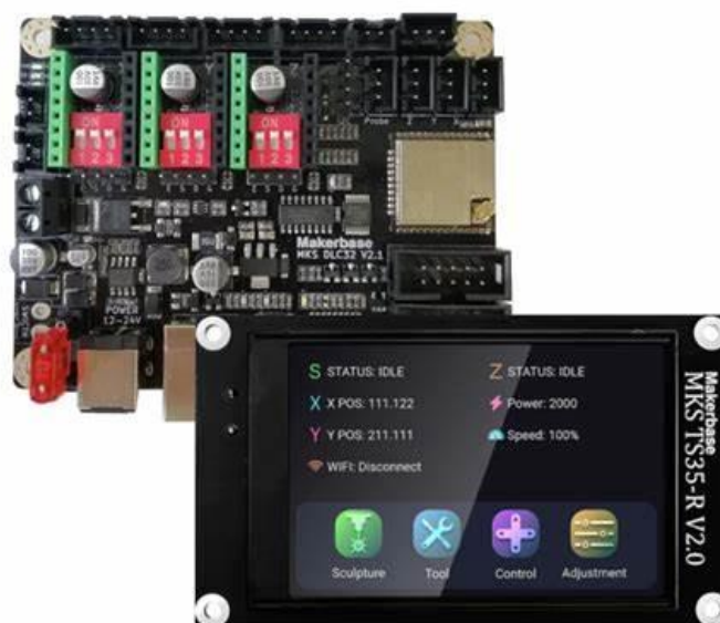
Figure 31. Le microcontrôleur MKS dlc V2.1 avec leur écran.[25]
