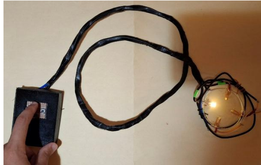
Figure 30: Système de commande des sources lumineuses du prototype.
