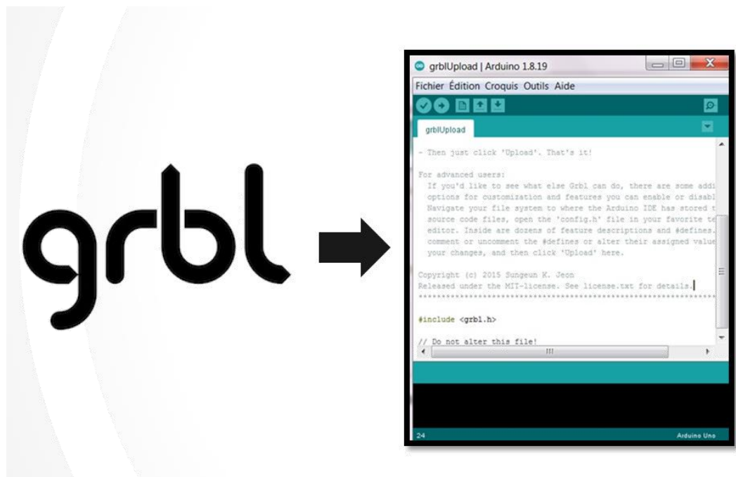
Figure 59: téléversement le micro-logiciel GRBL à l'aide d'arduino IDE
