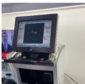
Figure 0-30) : L'appareille permet relever la forme exacte de la monture
