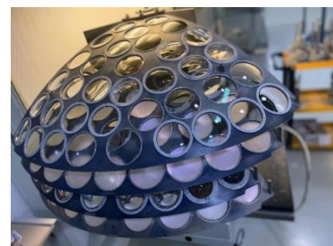
Figure (IV-22) : les supports rotatifs
