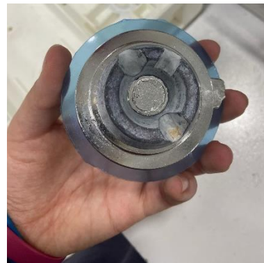
Figure (IV-14) : un semi-fini bloqué sur un support.
