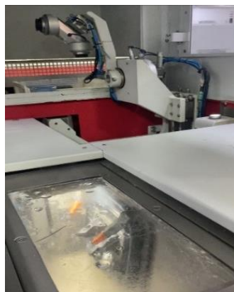
Figure (IV-16) : taillage du verre effectué à l'aide d'un
