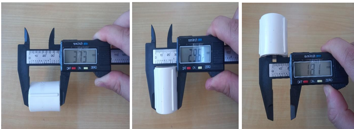
Figure 40 : Mesure dimensionnelle d'un raccord à l'aide d'un pied à coulisse numérique
