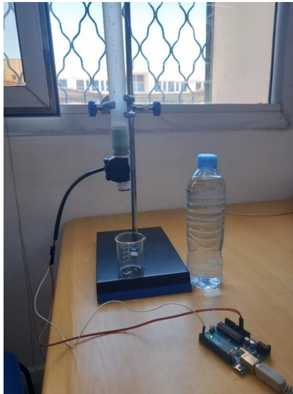
Figure 41 : Test du fonctionnement débitmètre YF S-201
