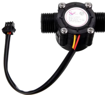
Figure 23 : Capteur de débit d'eau Yf-s-201 (17)
