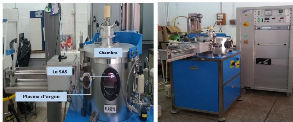
Figure III. 2: Bâti du pulvérisateur cathodique magnétron R.F du Laboratoire LPCMME.
