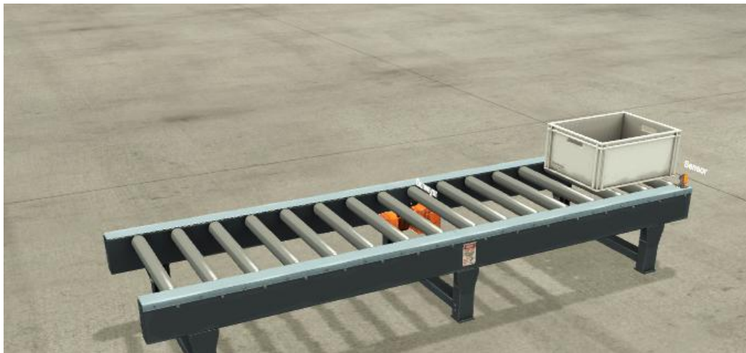
Figure 21 : Le moteur s'arrête immédiatement lors de la détection
