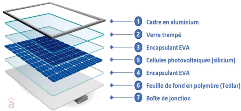
Figure I.8. Structure d'une cellule photovoltaïque
