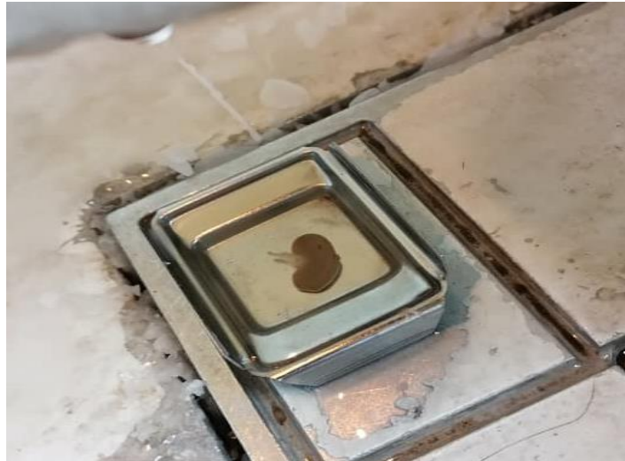
Figure 12 : Fixer l'échantillon dans le moule
