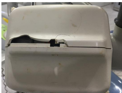
Figure 58 : Cache défectueux d'un cône radiogène
